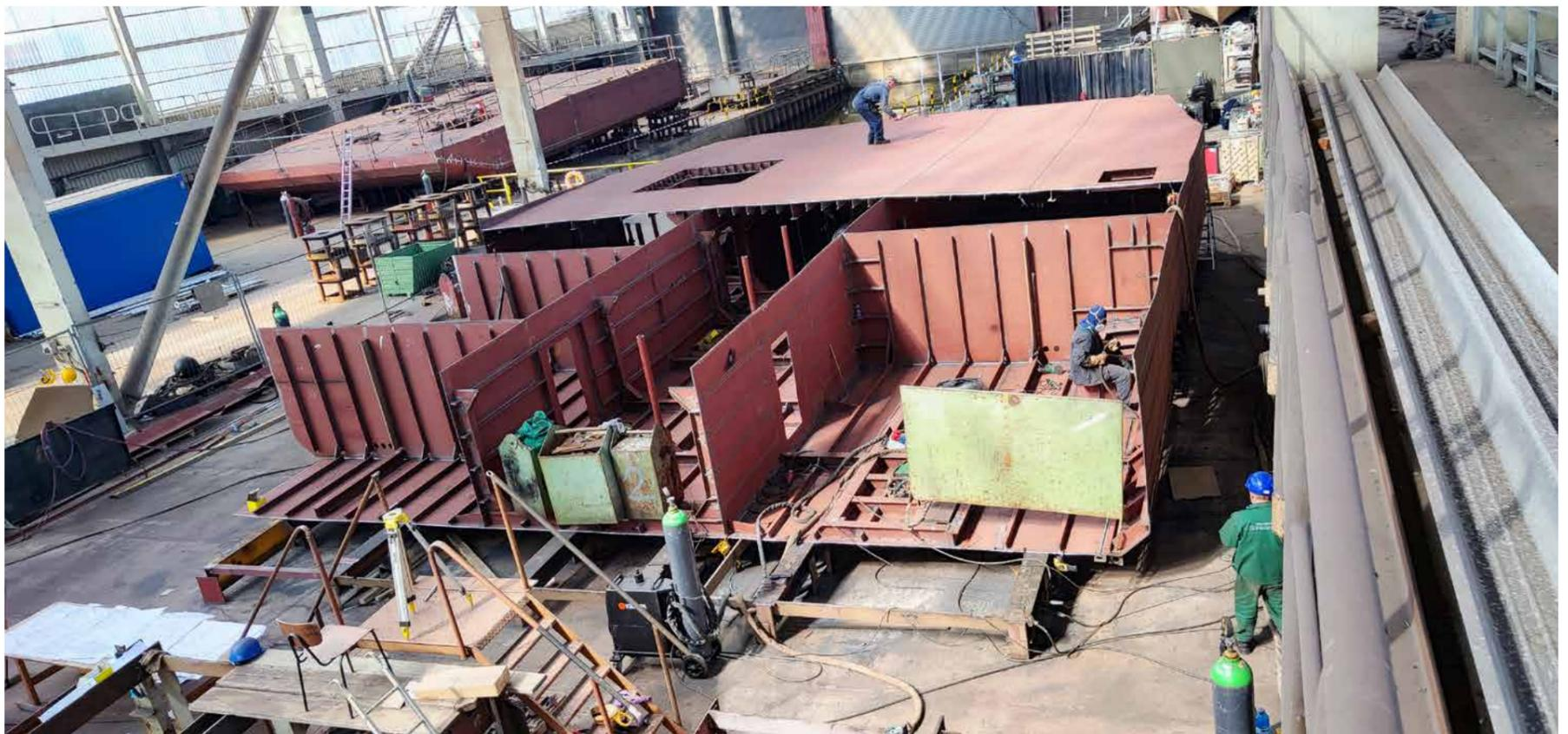
Der Selektionsbau der neuen Elbfähre schreitet voran. Schiffbau ist Handwerk. Schlosser, Stahlbauer und Schweißer gehören noch immer dazu. (© Hitzler Werft, Lauenburg)
