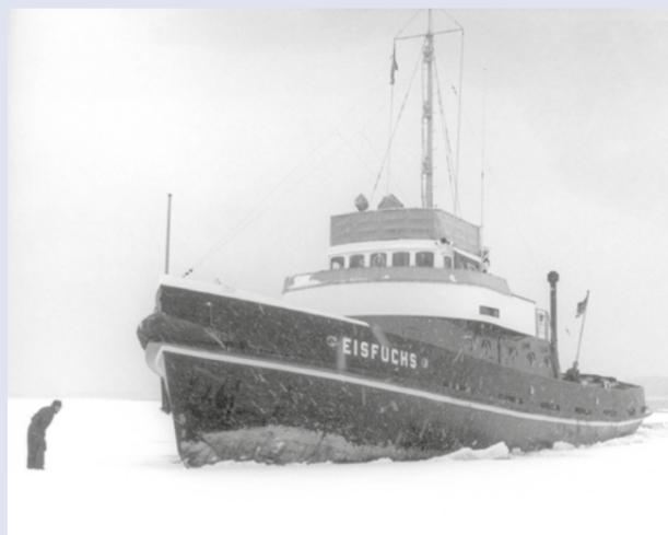
Der Eisbrecher EISFUCHS punktete mit 1100 PS und wurde für die WSD Hamburg gebaut. (© Hitzler Werft, Lauenburg)
