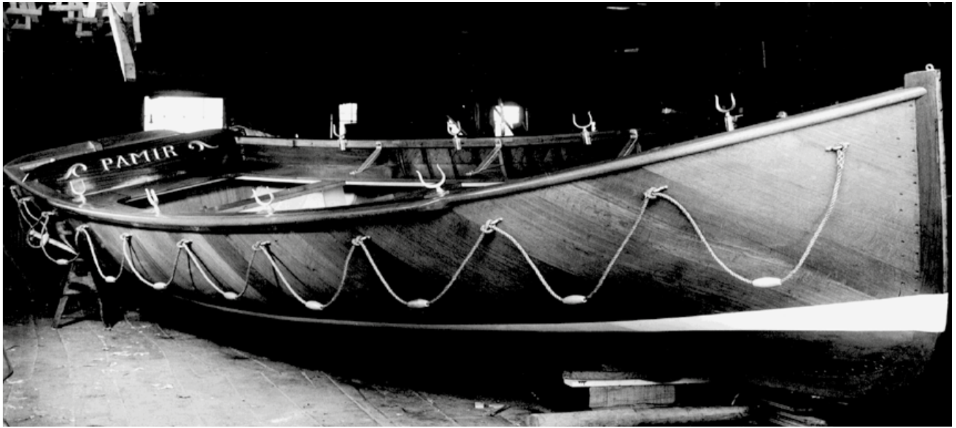
Geklinkertes Ruderboot, gebaut etwa 1925
